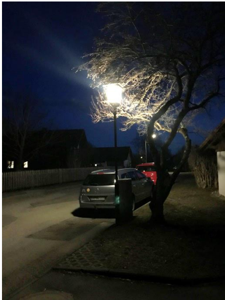
Bild 8: Am Geißbühl (9 W Leistung, LED 4000 K ab 30.07.2020, 7 h leistungsreduziert)
