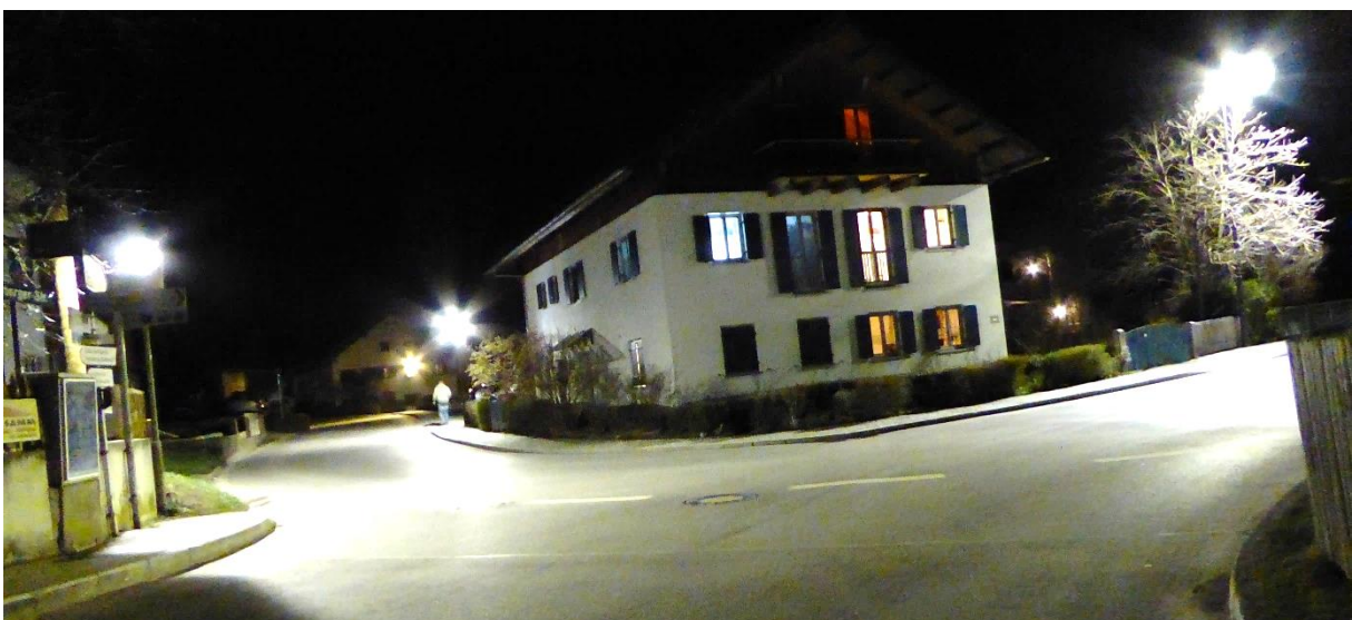
Bild 5: Schöffauer Straße mit Blick zur Achbrücke. Auch mitten in der Nacht ist es hier taghell. Hier wurden 2018 neue Teceo Koffer LED-Lampen (51 W Leistung mit 4000 K) installiert. Seitdem sind immer wieder Beschwerden der Anwohner über die zu helle Beleuchtung bei der Gemeinde eingegangen. Aktuell werden 4 LED-Lampen für 4 Stunden in der Nacht ausgeschaltet.
