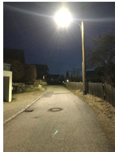
Bild 8: Am Geißbühl (9 W Leistung, LED 4000 K ab 30.07.2020, 7 h leistungsreduziert)
