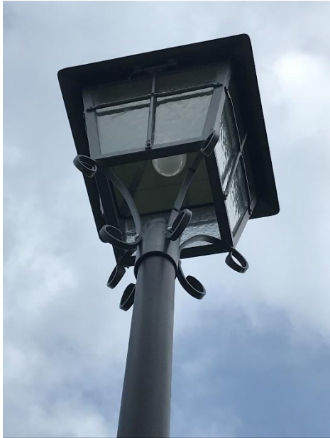
Bild 3: Blick in Testlampe mit Standard E27 Leuchtmittel
